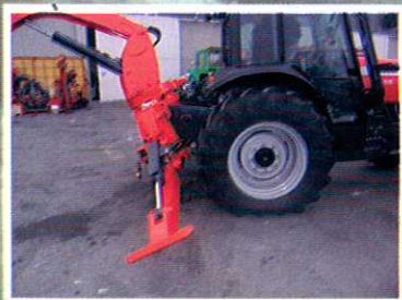
AGGANCIAMENTO ORIENTABILE PER AUTOLIVELLAMENTO
